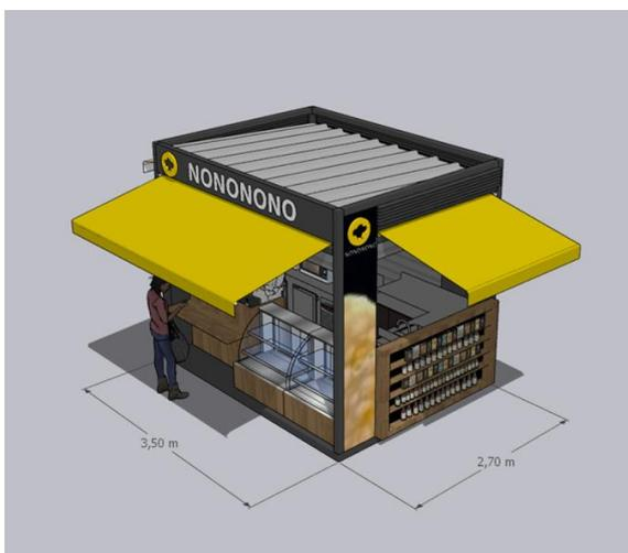
Figura 02 – Ilustração do esquema de toldos retráteis e portas de piso ao teto que propiciam maior flexibilidade de uso dos quiosques.
